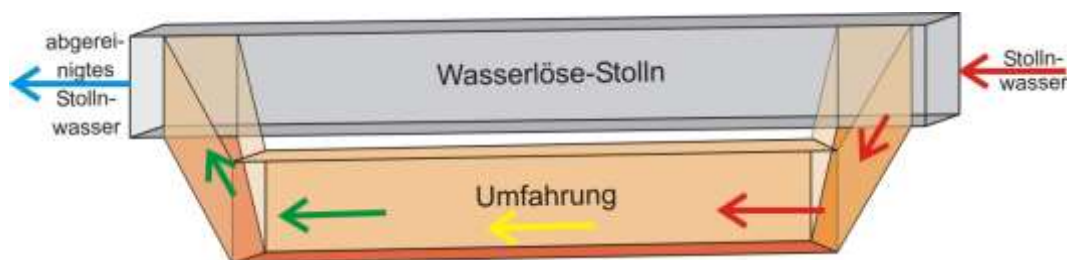
Abbildung 25: Konzept einer Reaktionsstrecke (Adsorption an Kalksand).
